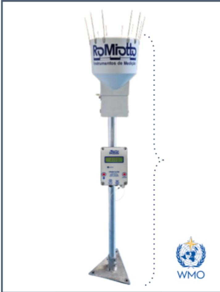
**Pluviógrafo** é um sistema desenvolvido e montado pela RoMiotto, para medição de quantidade e intensidade de chuva, com gravação de dados, onde além do monitoramento local em tempo real, através do Display LCD, é possível fazer o download dos dados ao conectar cabo no Registrador.
