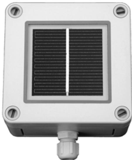
Célula de silício monocristalina, laminada sob vidro solar especial com baixo teor de ferro para excelente resistência aos raios UV e estabilidade a longo prazo.
